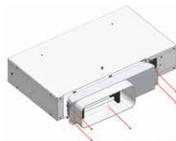
Trek de plaat met de Naber-aansluiting en elektrode voorzichtig ca. 50 mm naar buiten.
